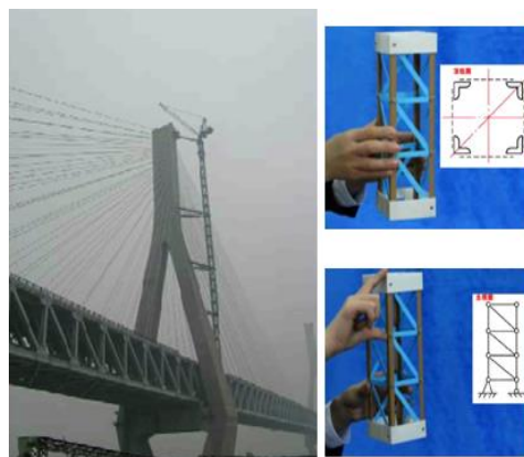
用塔身模型轻松地解释压杆稳定知识在塔吊中的运用。
