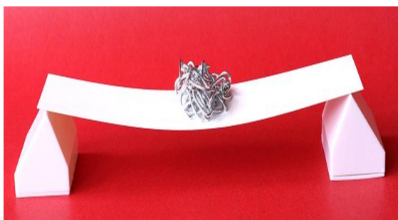
纸板放上链条，纸板向下变弯，体现力与变形一致性原理。
